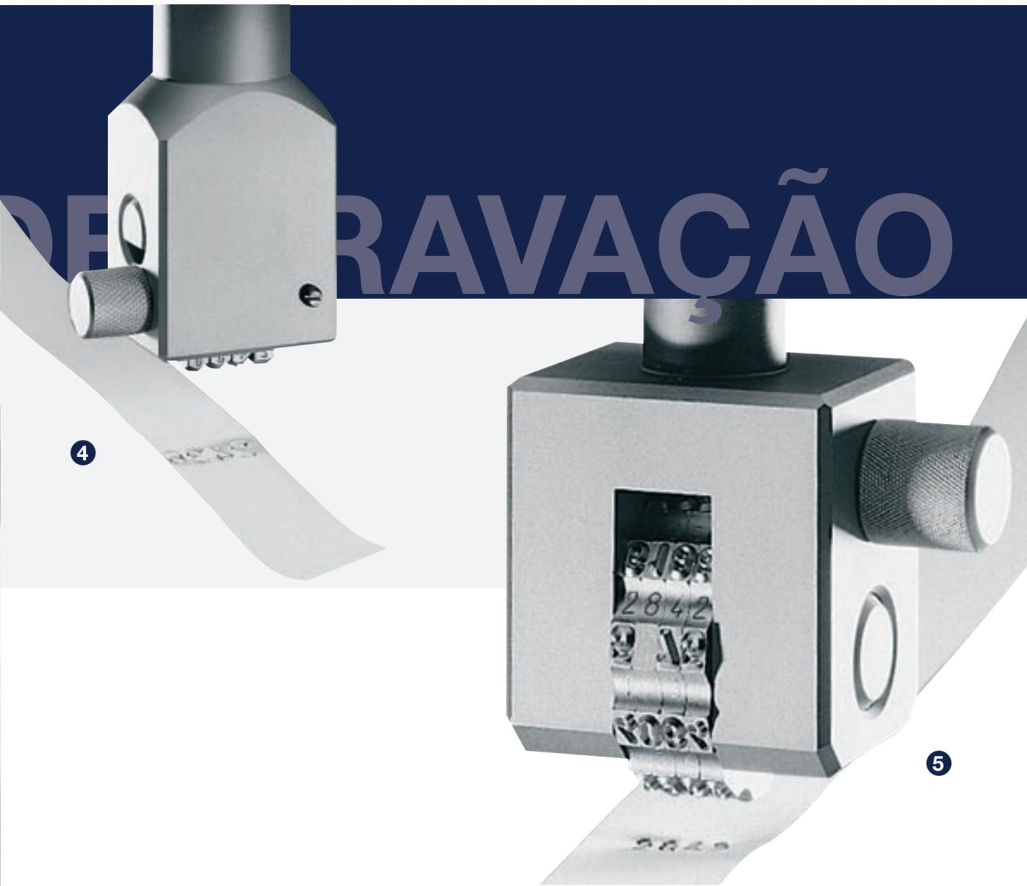
A marcação superficial com dados importantes, como a identificação de materiais, é muito importante, do ponto de vista de um sistema de GQ (garantia de qualidade). A possibilidade de substituição permite uma **MARCAÇÃO IMPORTANTE** maior flexibilidade.
