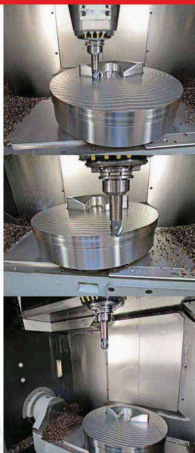
Ruhig, schnittig, prozesssicher: Die Prägevorrichtung für einen eiligen Kunden wurde bei Bornemann mit dem iMX-Schaftfräfersystem von Mitsubishi Materials geschruppt.
